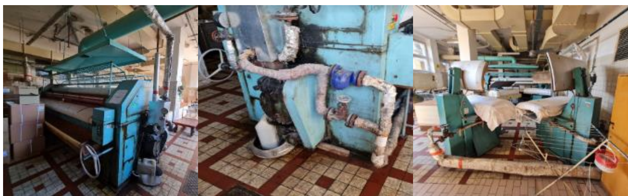
Obrázek 38 : Parní kalandr, detail napojení páry do parního kalandru, parní žehlení, zespodu napojení na potrubí
