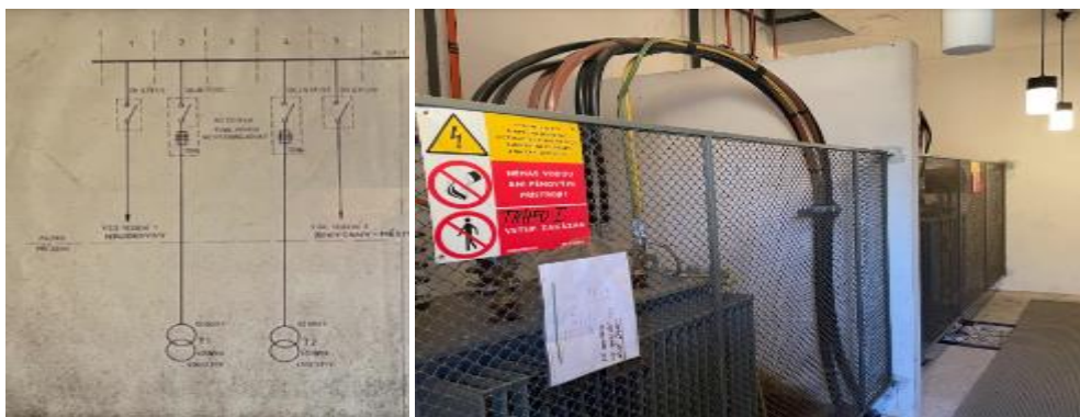
Obrázek 25 Schéma zapojení transformátorů a umístění transformátorů
